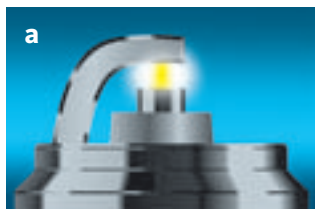
Elettrodo a tetto – elettrodo centrale (fig. a). Elettrodo laterale – elettrodo centrale (fig. b).
