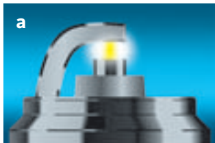
Dachelektrode – Mittlelektrode (Abb. a).
