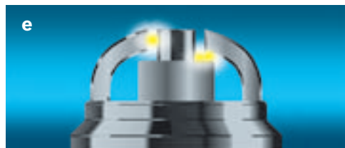
Eléctrodo lateral – Eléctrodo central ou eléctrodo lateral – Superfície do isolador – Eléctrodo central
