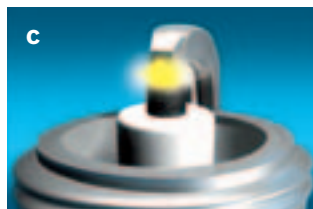
Elettrodo di massa profilato – elettrodo centrale (fig. c).
