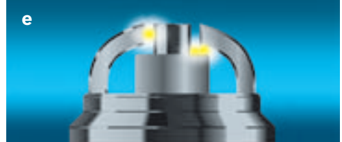
Zijelektrode – middenelektrode of zijelektrode – isolatoroppervlak – middenelektrode
