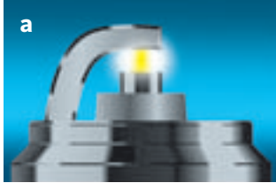
Electrode frontale – Electrode centrale (Fig. a). Electrode latérale – Electrode centrale (Fig. b).
