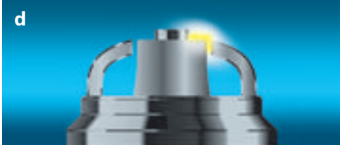
Zijelektrode – isolatoroppervlak – middenelektrode
