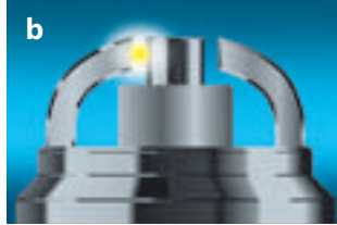
Electrode de masse profilée – Electrode centrale (Fig. c).
