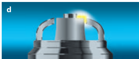
Electrode latérale – Tête d'isolateur – Electrode centrale
